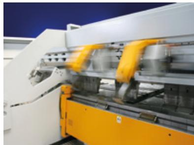
Der Werkzeugwechsler baut die gewünschte Biegelänge auf.
