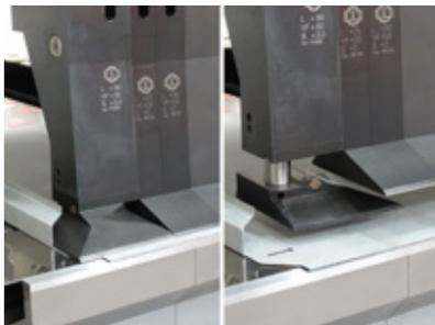
Automatisch ein- und ausdrehende Eckstücke komplettieren die Oberwangenwerkzeuge.
