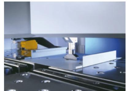
Der Hauptmanipulator dreht und positioniert das Blech mit einer Genauigkeit 1/1000 Grad und 1/100 mm. Damit lassen sich auch schrägwinklige Platinen perfekt biegen.
