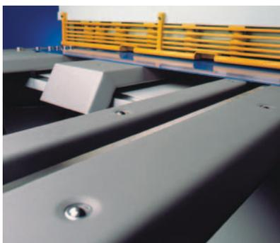
Seitlich und vorne abgeschrägte Scherentische mit Kugelrollen.
