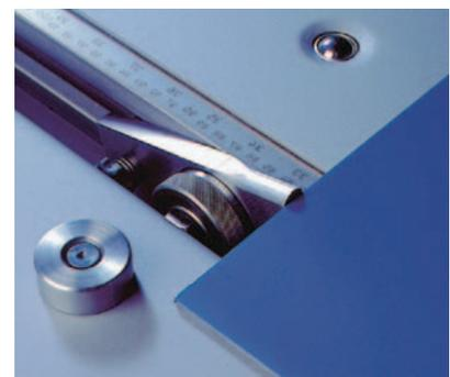
Kippanschläge (wahlweise mit Präzisionsskala) erlauben ein exaktes Positionieren der Bleche.
