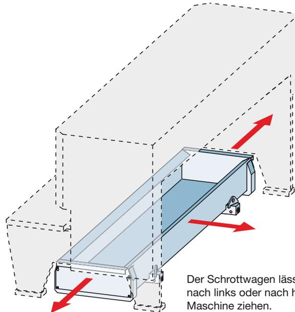
Der Schrottwagen lässt sich nach rechts, nach links oder nach hinten aus der Maschine ziehen.
