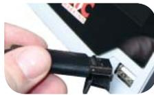
■ USB-Anschluss an der Vorderseite: Import / Export von Markierdateien, Tastaturanschluss
