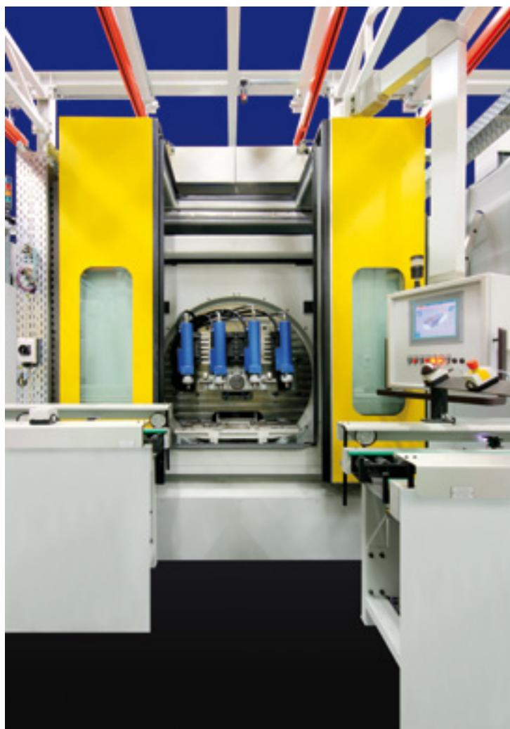
System zur Entkernung von Gussteilen. Sandkerne und anhaftende Sande werden über elektrische und hydraulische Klopf-, Vibrations- und Schwenkaggregate gelöst, zertrümmert und ausgeschüttelt.
