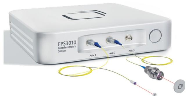
**Abbildung 2:** Das 3-Achsen Echtzeitinterferometer attocube FPS3010 bietet  $25 \text{ pm}$  Positionsauflösung und eine Messbandbreite von  $10 \text{ MHz}$ . Die faserbasierten Messköpfe sind – je nach Einsatzzweck – in verschiedenen Größen von  $4$  bis  $14 \text{ mm}$  Durchmesser erhältlich und sowohl mit Ultrahochvakuum als auch kryogenen Umgebungsbedingungen kompatibel.
