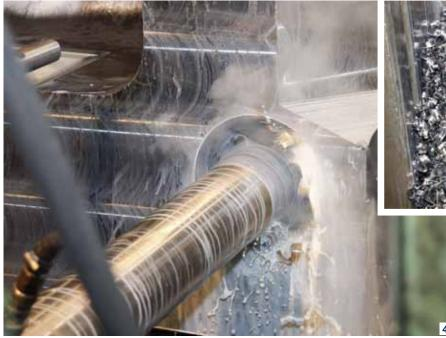
4 Durch die richtige Werkzeugauslegung und Bearbeitungsstrategie konnte die Bohrzeit pro Bohrung von 3,25 Stunden auf 25 Minuten reduziert werden.
