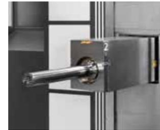
Bohrpinole Ø 130 & 150mm mit 800mm Hub
