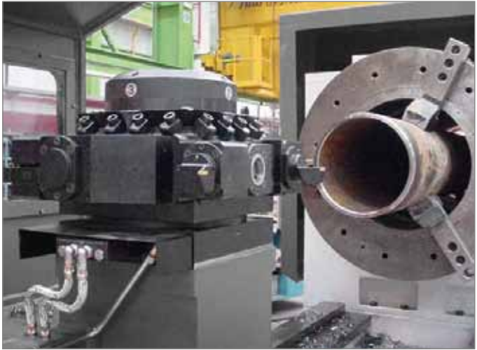
Durchlassbohrungen der Hauptspindel bis 600 mm. Main spindle bore up to 600 mm.
