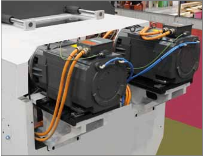
Spindelkasten mit Doppelmotor. C-Achse mit Genauigkeit 0,001°. Headstock with twin motor. C axis accuracy 0,001°.
