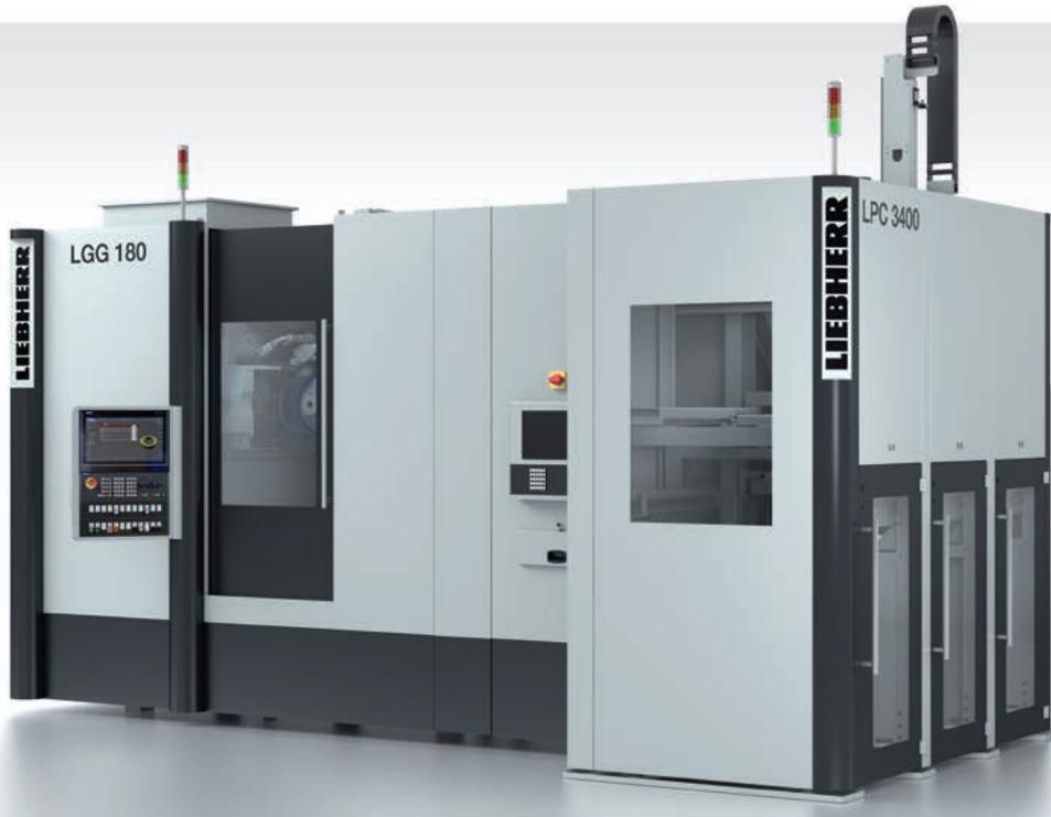
Für die Hartfeinbearbeitung von Zahnrädern und Zahnwellen bietet die LCS-Baureihe von Liebherr ein optimales Maschinenkonzept. Die Verzahnungsschleifmaschinen sind für Werkstücke bis zu einem Durchmesser von 1.250 mm geeignet, sind vielseitig einsetzbar und sehr produktiv.
