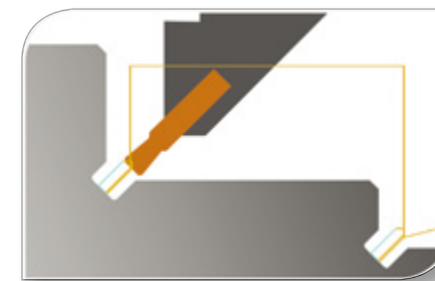
Einstechen unter frei definierbarem Winkel
