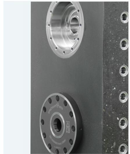
Rostbeständige Einbautaschen und innenliegende Pneumatik-Versorgung für sicheren Betrieb im anspruchsvollen Umfeld der Produktion.
