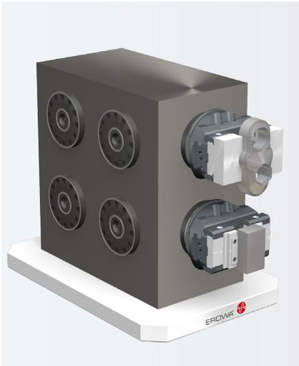
Das Nullpunktspannsystem am Spannturm eliminiert die Umrüstzeiten. Vorbereitet werden die Werkstücke auf dem Rüstplatz ausserhalb der Maschine. Bearbeitet wird horizontal.
