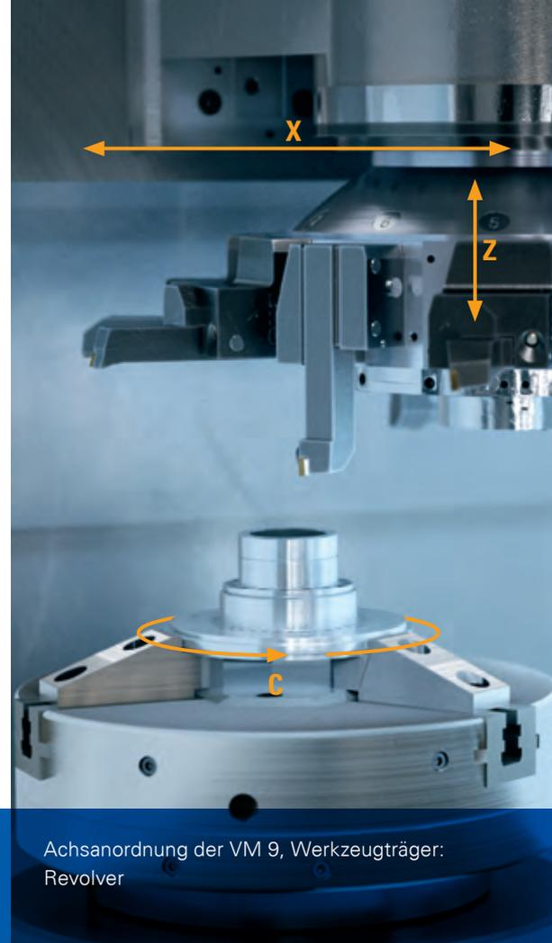
Achsanordnung der VM 9, Werkzeugträger: Revolver
