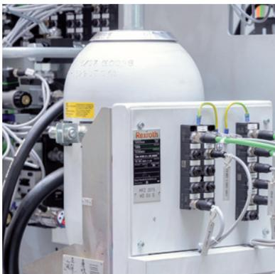
Druckspeicher der Hydraulikanlage
