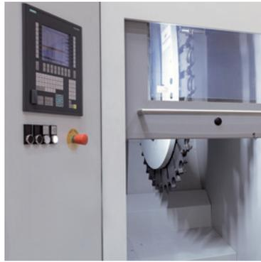
Zugang Werkzeugbeladung mit Ansteuerung über Service-Panel
