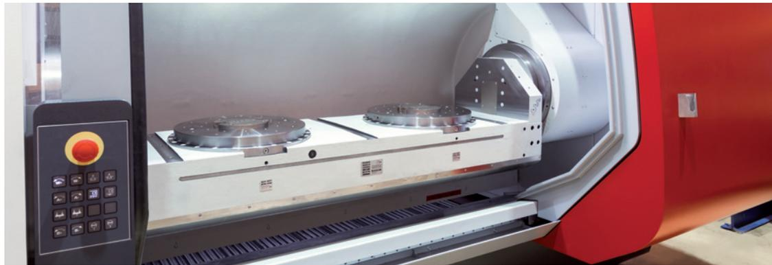
Werkstückträgerereinheit - PENDULUM CHANGER
