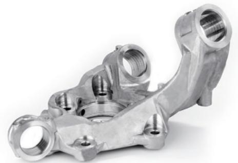
**Aluminium Radträger (Hinterachse)**
