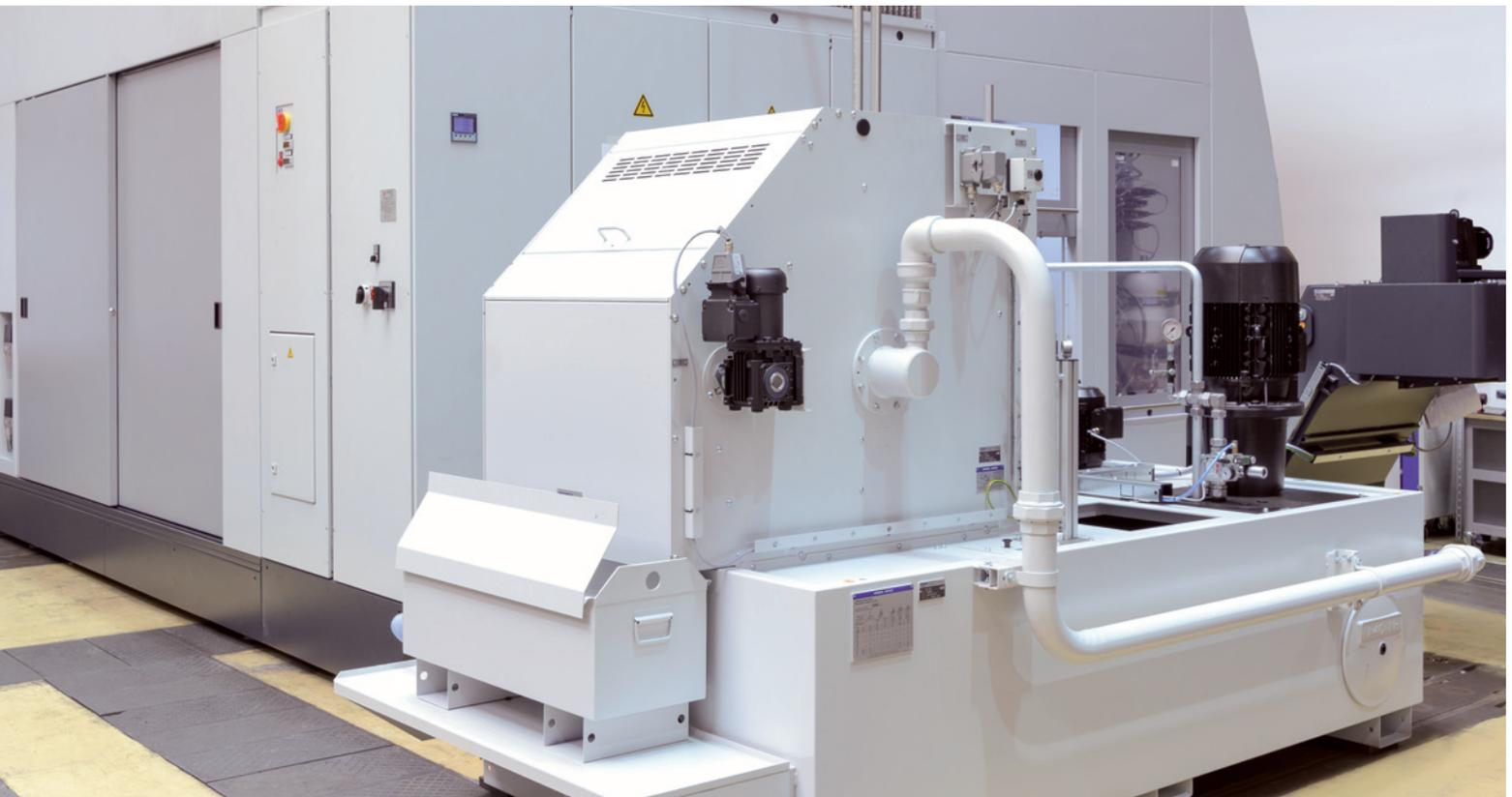
MFZ 9.2 linear mit Späneförderanlage
