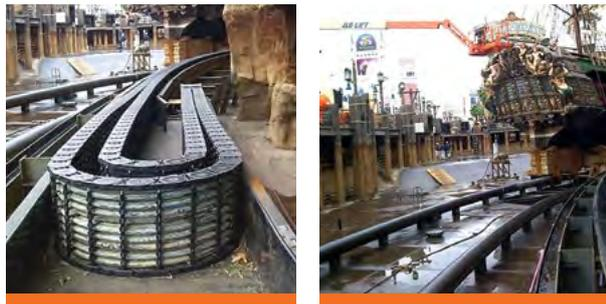
Auf der Seite liegende TL Energieführungskette aus Kunststoff für einen langen Verfahrsweg mit Drehung bei einer Attraktion in Las Vegas, Nevada, USA.
