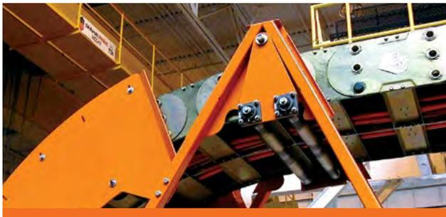
Blasformanwendung mit XL Stahl-Energieführungskette und patentiertem „Walker“-Unterstützungssystem zur Reduzierung der Stoßbelastung durch Vermeidung einer Blockierung des Gliedes.
