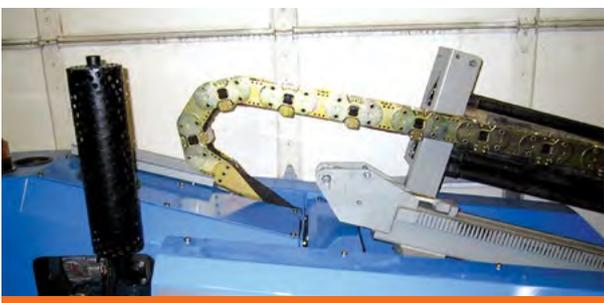
SRC Stahl-Energieführungsketten mit Aufbaustegen an einer Horizontalbohranlage.
