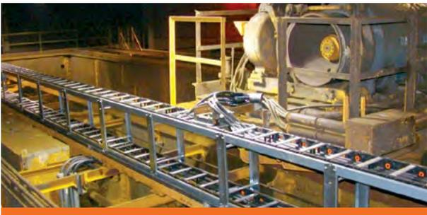
Hochgeschwindigkeits-Stützwagen mit TS Energieführungskette aus Kunststoff für langen Verfahrsweg in einem Stahlwerk.
