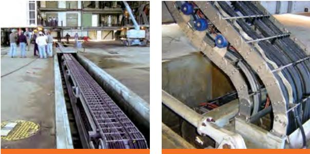
LRC-Serie: Individuelles Energieführungskettensystem aus Stahl mit Stützwagen in einer Raketenabschussanlage am Luftwaffenstützpunkt Vandenberg in Kalifornien.
