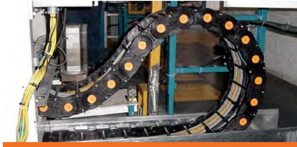
TL Energieführungskette aus Kunststoff mit abgesenkter Montagehöhe für höhere Zugkraft bei langem Verfahrsweg.
