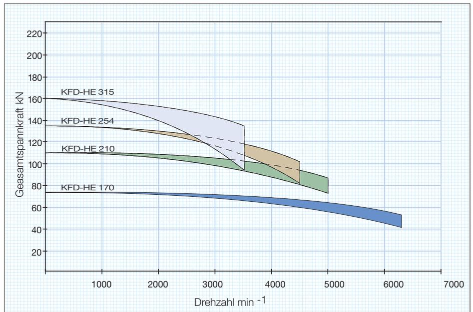
Für die angegebenen Werte der Spannkraft wird ein einwandfreier Zustand des Spannfutters vorausgesetzt. Sie gelten nach dem Abschmieren mit dem von RÖHM empfohlenen Fett F 80. Der Messpunkt ist nahe der Futter-Planseite anzusetzen.
