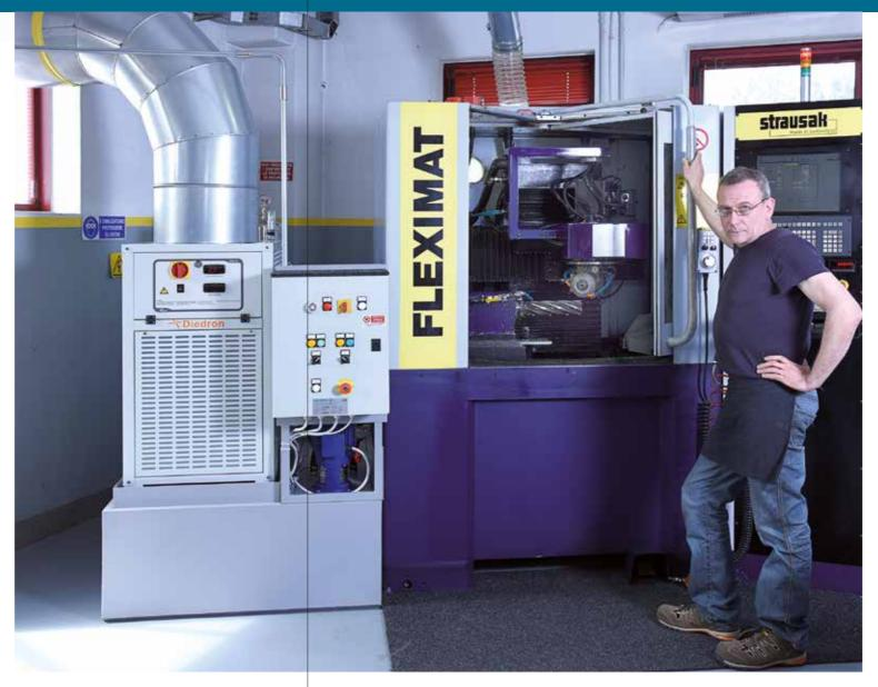
"Die Filteranlagen von Diedron werden in großem Stil auch beim Werkzeugschleifen eingesetzt. Bei diesen filigranen Prozessen – wie hier bei einem Spezialisten in Italien – tragen die Filteranlagen wesentlich zur Produktqualität bei."
