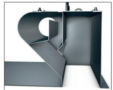
Durch die Strömungsschleuse prallen erfasste Späne ab und fallen in den Arbeitsraum zurück. Zudem sorgt der entstehende Zyklonwirbel für ein teilweises Vorabscheiden der angesaugten Stäube und Kühl-Schmierstoffe
