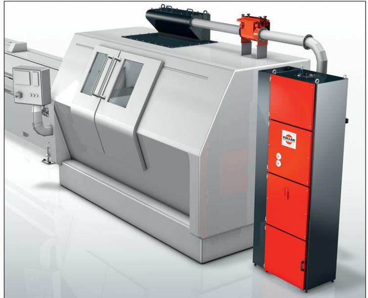
Einzelabscheider TR-1 ProVent Plus an einem Drehzentrum
