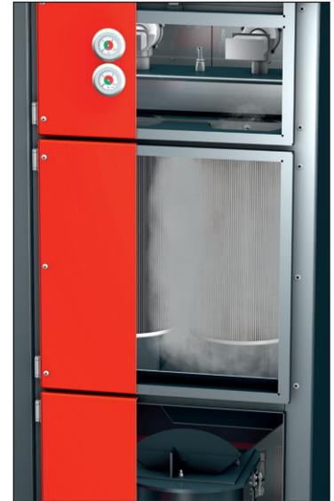
Bei der Druckluft-Impulsabreinigung der Filterpatronen wird der Staub dispergiert und damit explosionsfähig
