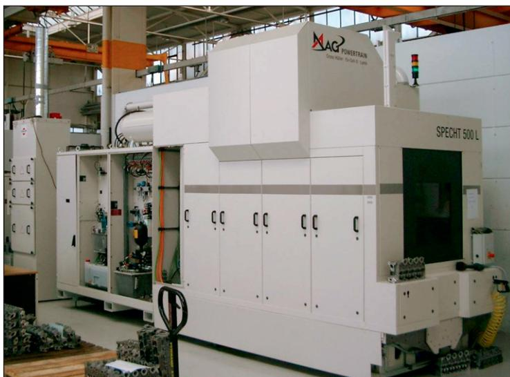
TR-1 ProVent Plus als Einzelabscheider einer Werkzeugmaschine zur Fertigung von Motorblöcken- und köpfen, bei der Grauguss- und Aluminiumstäube entstehen
