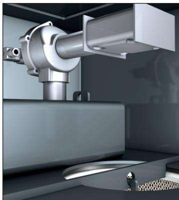
Der Druckluftimpuls zur Abreinigung der Filterpatronen wird bei allen Ausführungen des TR-1 Einzelabscheiders durch einen Druckluftspeicher mit elektromagnetischen Membranventilen erzeugt
