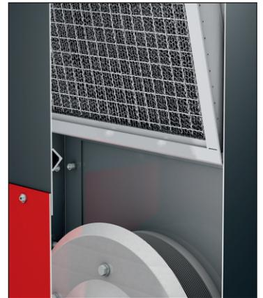
Der neue druckstoßfeste Schutzschacht nimmt die Druckwelle aus dem Druckentlastungsventil auf. Integrierte Edelstahlgestrickfilter halten Verbrennungspartikel zurück und absorbieren die austretende Wärmeentwicklung
