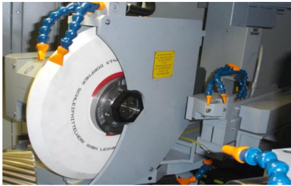
Beispiel für eine Außen- und Planschleifeinheit im Winkel von 45° zur Werkstückachse mit einer zweiseitig profilierten Außen- und Planschleifscheibe
