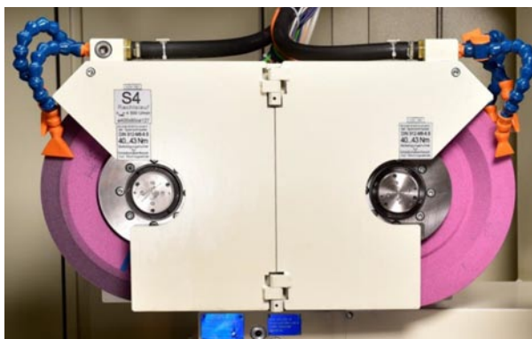
Beispiel für eine Außen- und Planschleifeinheit im Winkel von 90° zur Werkstückachse mit einer geraden (zylindrischen) Außenschleifscheibe
