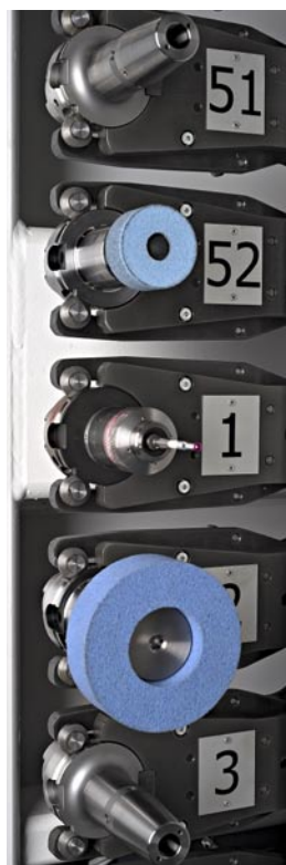
Beispiel für einen 52-fach Wechsler und den Wechselprozess zur Komplettbearbeitung komplexer Bauteile in nur einer Aufspannung
