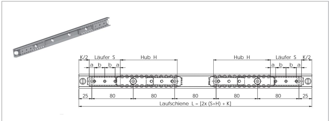
Bei Systemen der Version 2 in der Baugröße 63 mit zwei unabhängigen Läufern ändert sich das K-Maß von 80 mm auf 110 mm und bei jedem weiteren Läufer um zusätzlich 30 mm
