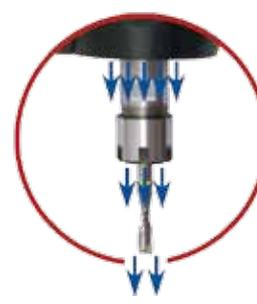
optimaler Kaltluftstrom (bis -25°C) für Werkzeugkühlung und Späneabtransport
