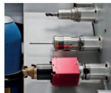
Werkzeug, Messtaster und Laserschweißeinheit im Werkzeugwechsler
