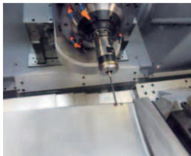
3D Vermessung einer Turbinenschaufel in der HSTM
