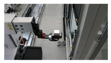
Ein wesentlicher Punkt zum Erreichen des OEE Faktors ist die automatische Beladung der Maschinen. Auch in der zweiten und dritten Schicht, aber ohne Maschinenbediener, sollen die Anlagen fertigen.
