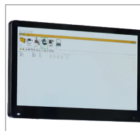
Mini PC inkl. Monitor ER-147724 Integrierte Lösung für direkte Datenübertragung an das Leitsystem oder Bildübertragung von Kamerasystem.
