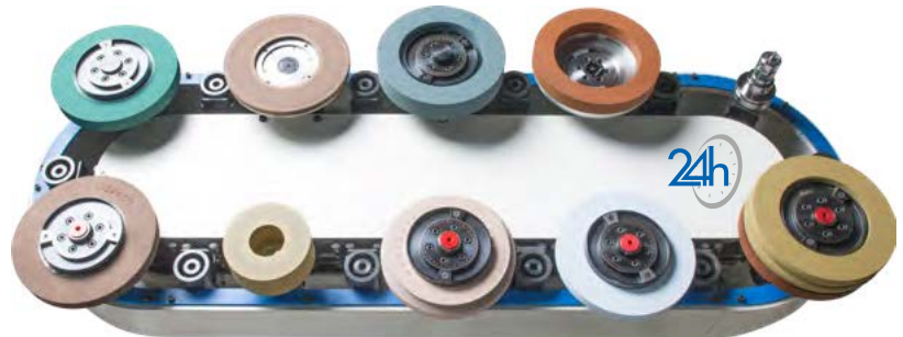
Werkzeugwechsler mit einer Kapazität bis zu 20 Werkzeugen. Verwaltung von Schwesterwerkzeugen.
