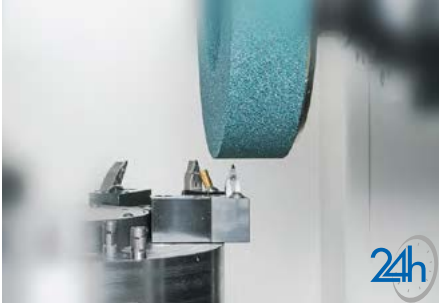
Automatisches Abrichten der Schleifscheiben mit Werkzeugkorrektur.
