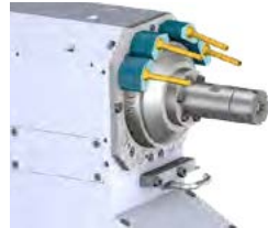
Kühlung des Kopfs der C-Achse
