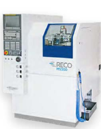
RECO-MS300/310 Satinieren komplexer Oberflächen mit Schleifbändern.
