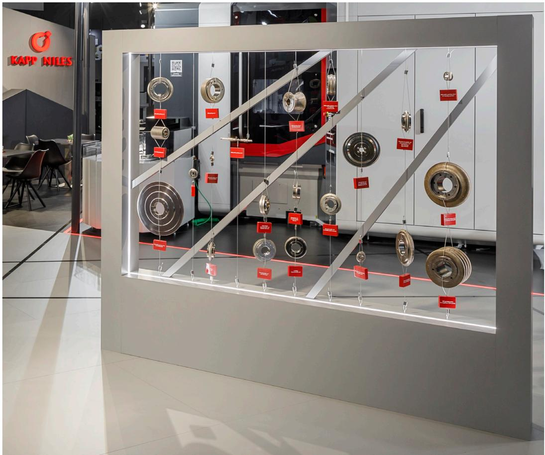
Werkzeugwand mit verschiedenen Schleif- und Abrichtwerkzeugen
