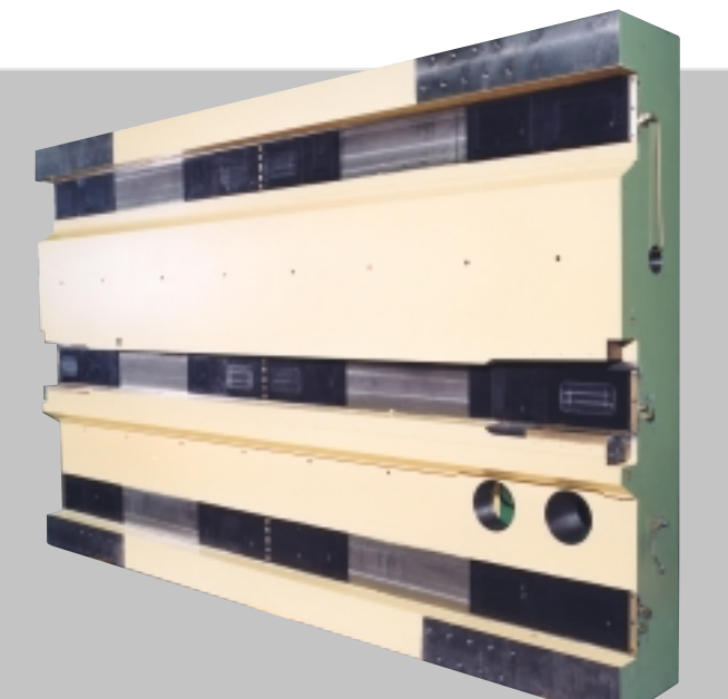
Ständer-Bettschlitten Unterseite mit abgeformten Führungsbahnen und Hydrostatiktaschen
