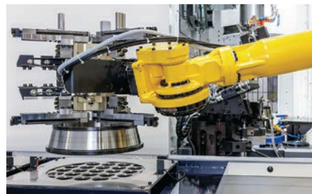
■ロボットによる自動搬送 Automatic conveyor controlled by robot
