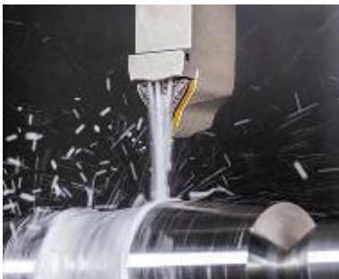
Bild 3: Die Halter für die x- und die y-Achsen-Bearbeitung beider Systeme verfügen über eine zielgerichtete Jet-Kühlung, die das Kühlmittel direkt in die Schnittzone bringt und die Schneide von zwei Seiten zugleich kühlt.
