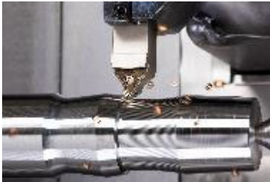
Bild 2: Den flexibel einsetzbaren QUICKTLOCK hat ISCAR zum multidirektionalen Längs-, Plan- und Profildrehen unter Hochvorschub auf Kurzdrehern und Multi-Tasking-Maschinen entwickelt.
