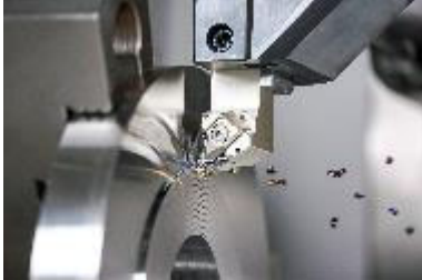
Bild 1: Den sechsschneidigen QUICKTURN mit T-LOCK-Klemmsystem können Anwender zum schnellen multidirektionalen Plan- und Profildrehen auf der x- und y-Achse einsetzen.
