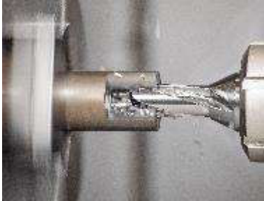
Bild 1: Mit den neuen F3B-Aufbohrköpfen für die QUICK3CHAM-Bohrer kann der Anwender vorhandene Bohrungen aufbohren, auch wenn diese exzentrisch angebracht sind.
