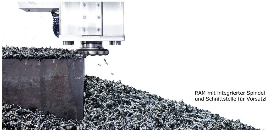
RAM mit integrierter Spindel
