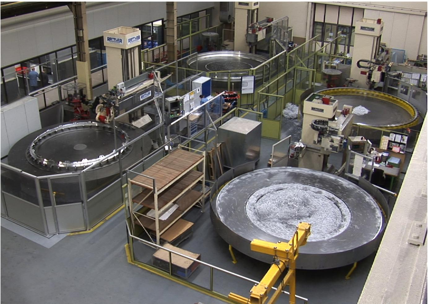
Bearbeitung von Ariane-Bauteilen auf ROTTLER-Bearbeitungszentren
