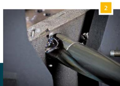
2 Präzises Bohren bis zu Ø 40 mm
