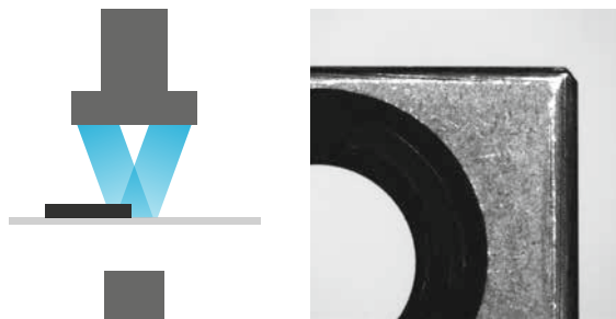
▲ Prinzip einer Auflichtmessung: Hier sind obendrein detaillierte Oberflächenmerkmale erkennbar – wie beispielsweise in der Abbildung die Fase der Bohrung.
