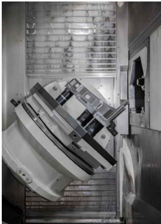
Bild Nr. 99-02 AM_KO-Schwenktisch1.jpg. Auf fast allen der 22 Maschinen bei Koller in Dietfurt sind AMF Nullpunktspannsysteme im Einsatz.
