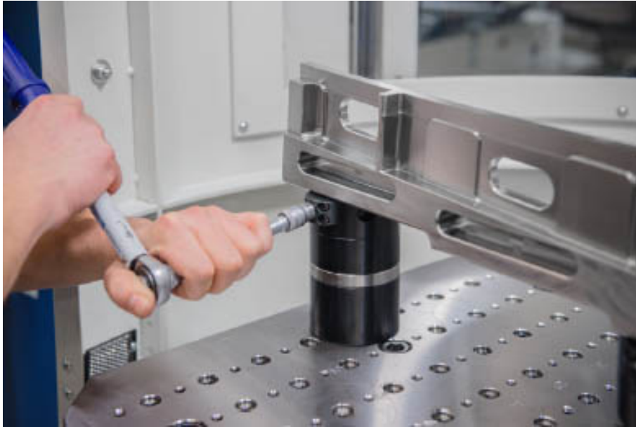
Bild Nr. 99-05 AM_KO-Lösen.jpg. Rüstzeiten mit AMF Nullpunktspanntechnik minimieren: Mit wenigen Handgriffen ist das Werkstück gespannt.
