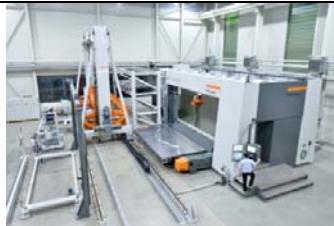
Pic_4: HBZ AeroCell 500/250 mit Palettenregal und RGV (= rail guided vehicle) zur Verkettung von insgesamt 6 Maschinen
