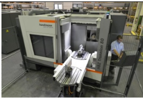
Pic_5: HBZ Trunnion 80 mit Handtmann Palettenwechsler für zwei Paletten
