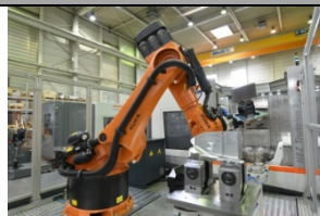
Pic_2: SINUMERIK-basierte Roboterautomation. Intelligente Lösung für automatisiertes Materialhandling und Nachbearbeitungen außerhalb der Maschine via Roboter. Dank der Run MyRobot/Machining Schnittstelle sind keine Roboterkenntnisse notwendig.
