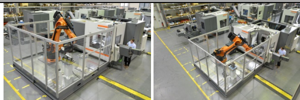
Pic_1: Die Kombination aus den beiden Steuerungen Siemens CNC SINUMERIK 840D sl und KUKA KR C4 ermöglicht die Steuerung aller Produktionsprozesse inkl. Maschine und Roboter über das Bedienpult der HBZ Trunnion.
