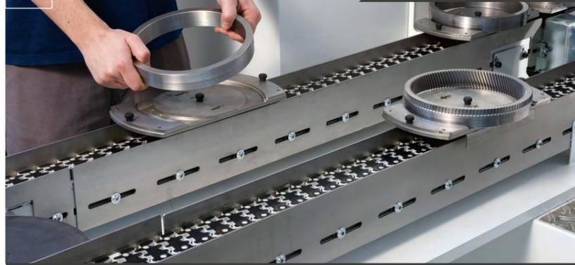
Eine Handbeladung kann direkt in den Arbeitsraum der PITTLER SkiveLine erfolgen oder taktzeit neutral über ein Shuttlesystem.
