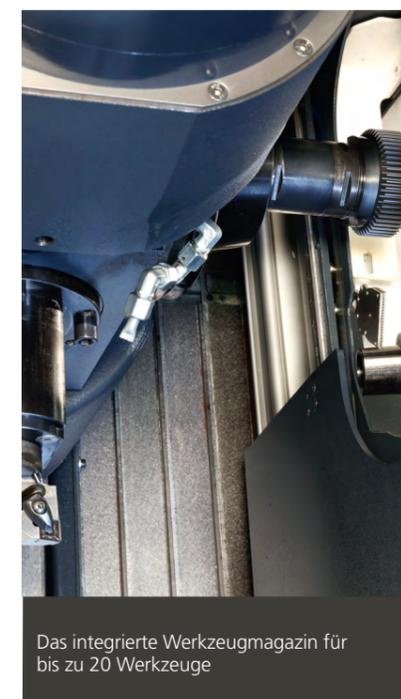
Das integrierte Werkzeugmagazin für bis zu 20 Werkzeuge
