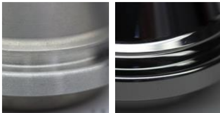
Falzrolle vor 0,44 \mu\text{m} (li) und nach 0,05 \mu\text{m} (re) der Bearbeitung durch den OTEC Streamfinish-Prozess
