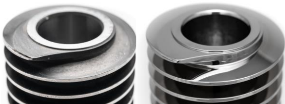
Förderschnecke vor (li) und nach (re) der Bearbeitung durch den OTECE Streamfinish-Prozess
