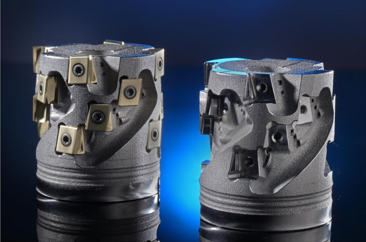
Mehrreihiges Demonstratorwerkzeug mit verlustarmer und zielgerichteter Kühlschmierstoff-Zufuhr zum Einsatz in Luftfahrt-Strukturbauteilen aus Titan (©Fraunhofer ILT, Walter AG, WZL der RWTH Aachen)
