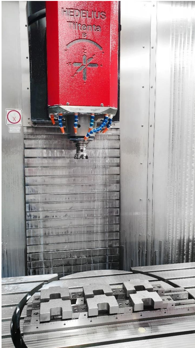
Bild 2: In einer Mehrfachspannung bearbeitet Kreiselmeyer jeweils sechs Halterungen für Kameragehäuse. Für diese Edelstahlteile ist höchste Präzision gefragt.
