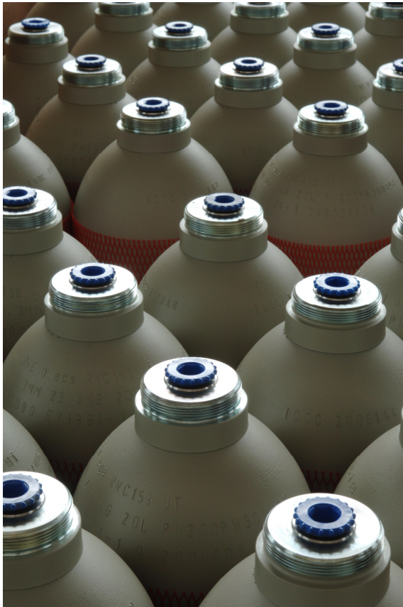
Die nahtlosen Hochdruckstahlflaschen und -behälter werden im Durchmesserbereich von 83 bis 267 mm, mit Volumen von 0,7 bis 80,0 Liter und einem Prüfdruck von 250 bis 450 bar hergestellt
