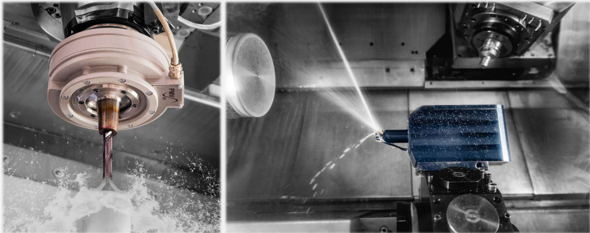
Abbildung 4 Schwingssysteme VIBROdrill ultrasonic und VIBROturn im Einsatz (v.l.n.r.)
