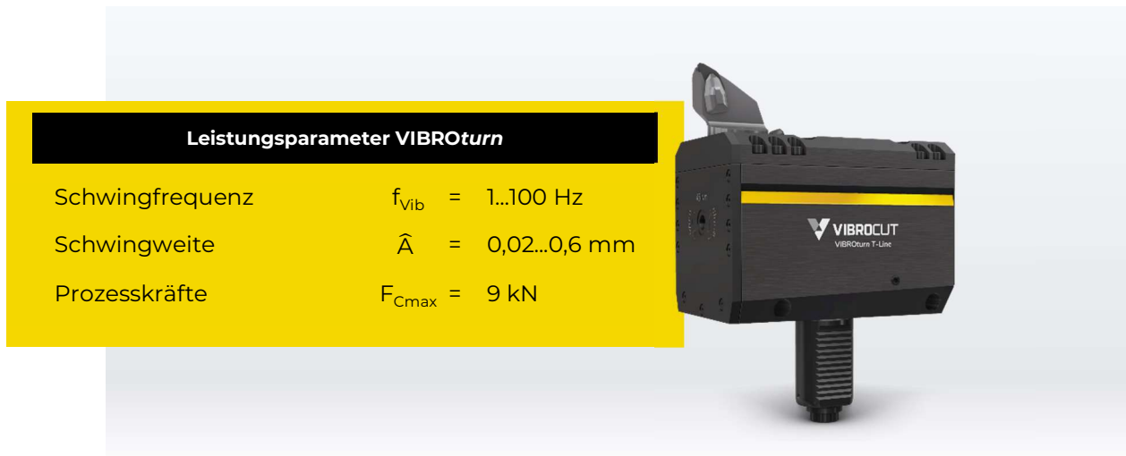
Abbildung 3 Dreh-Werkzeughalter VIBROturn zur Überlagerung niederfrequenter Schwingungen
