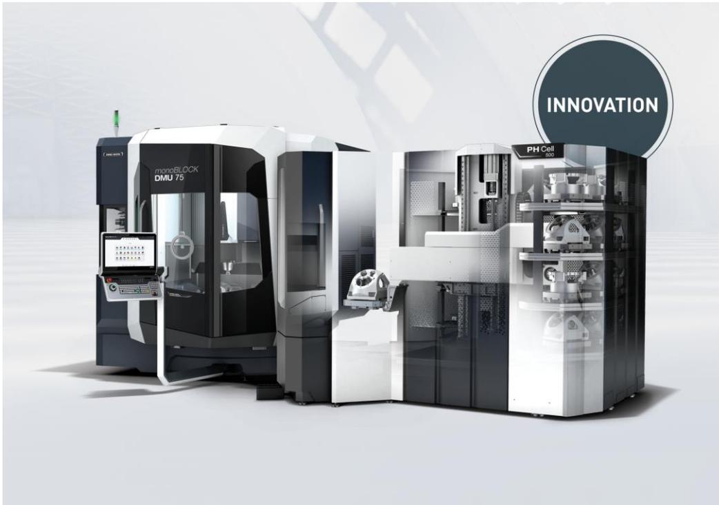
*Das modulare PH Cell 500 bietet Platz für bis zu 32 Paletten mit je 400 x 400 mm. Eine hohe Ergonomie und einfache Bedienung gewährleisten der drehbare Rüstplatz und die Steuerung per Touchscreen.*
