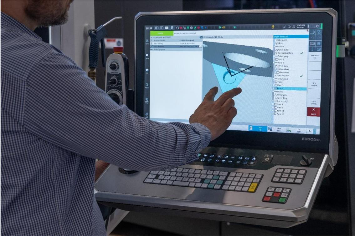
Mit Optimize MyProgramming /3D-Scanner können Anwender Programme direkt an der Steuerung erstellen und optimieren.
