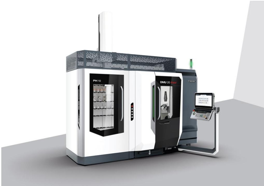
Automationslösungen wie das PH 10 steigern die Produktivität der DMU 20 linear in einer mannarmen Fertigung.
