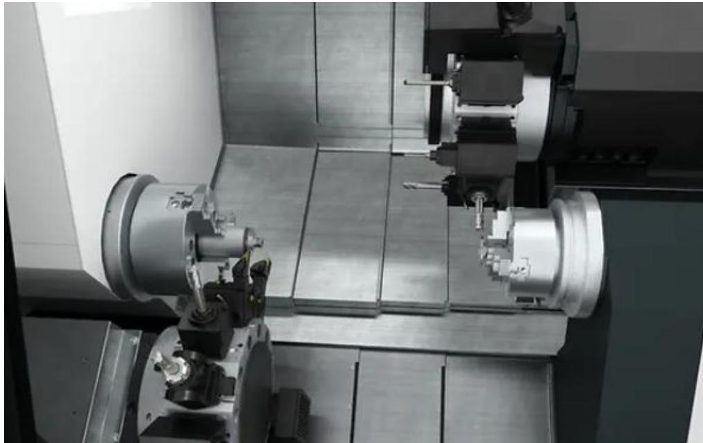
Die zwei Spindeln und die Vielzahl an Revolvern erlauben eine effiziente 6-Seiten-Komplettbearbeitung von Werkstücken mit bis zu Ø 430 x 700 mm.
