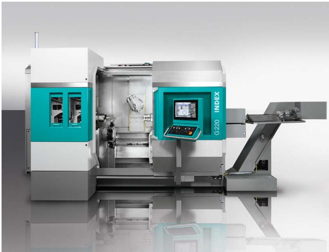
Die Entwickler von INDEX haben bei der Neukonstruktion der G220 ihre gesamten Erfahrungen aus den erfolgreichen Baureihen der R- und G- Maschinen eingebracht. Entstanden ist eine kompakte Maschine, die auf rund 10 m<sup>2</sup> Aufstellfläche (ohne Stangenlader) Dreh- und fünfachsiges Fräsbearbeitung auf gewohnt hohem Niveau bietet.
