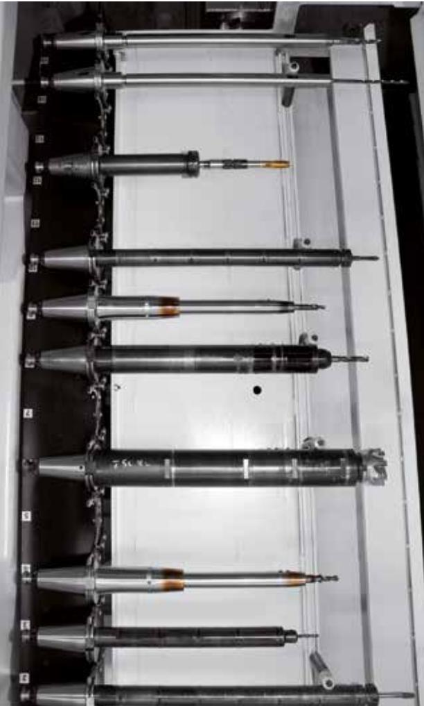
Das Turmmagazin der bei BOMAG installierten HEC 1600 bietet 180 Werkzeugplätze. Es besteht die Möglichkeit, lange Werkzeuge bis 800 mm vorzuhalten. BOMAG hat sich zudem für eine Sonderoption entschieden, die den Einsatz von Brückenwerkzeugen bis zu einem Durchmesser von 950 mm ermöglicht.
