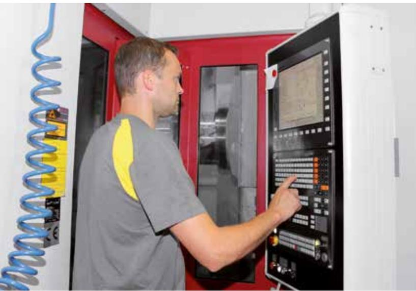
Die Heidenhain iTNC 530 ermöglicht einfache Werkstattprogrammierung und legt die Basis für Präzisionsbearbeitung.
