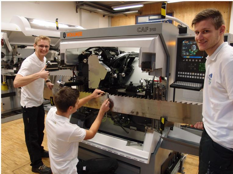
**Bildtext:** An der Vollmer CAF 310 lernen die Schülerinnen und Schüler des Holztechnikums Kuchl das automatische Schärfen von Band-, Gatter- und Kreissägeblättern an der Flankenfreifläche (Bild: Kuchl).
