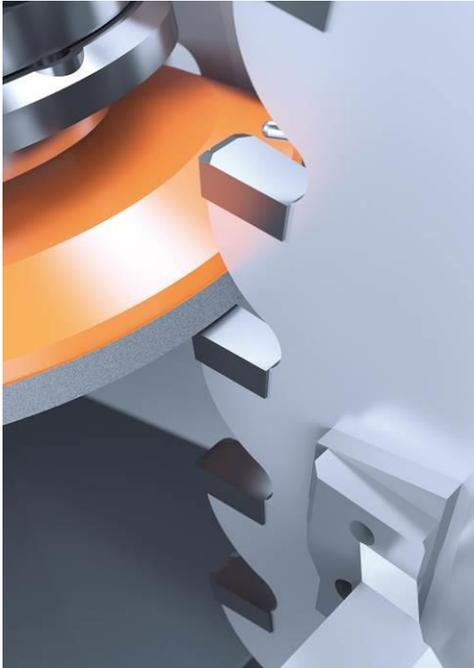
**Bildtext:** Bei der CHP-Maschine sorgt die verstellbare Schleifpinole zur Spanteilerbearbeitung für mehr Flexibilität in der Bearbeitung von Kreissägen für den Metallzuschnitt.
