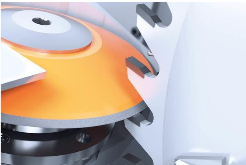
**Bildtext:** Hartmetallbestückte Kreissägezähne werden mit den Vollmer CHP-Maschinen an den Span- und Freiflächen bearbeitet.
