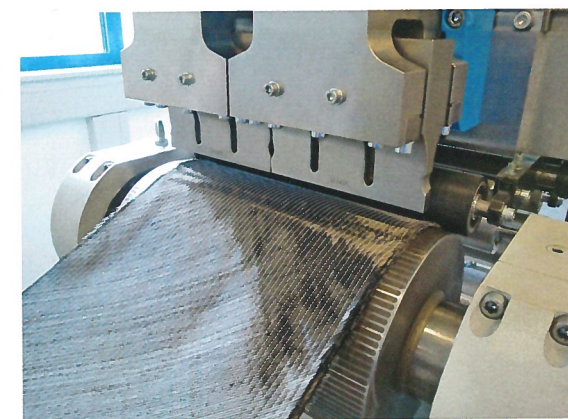
◀ Ultraschallmodul zum Verbinden von Carbonmaterial.
